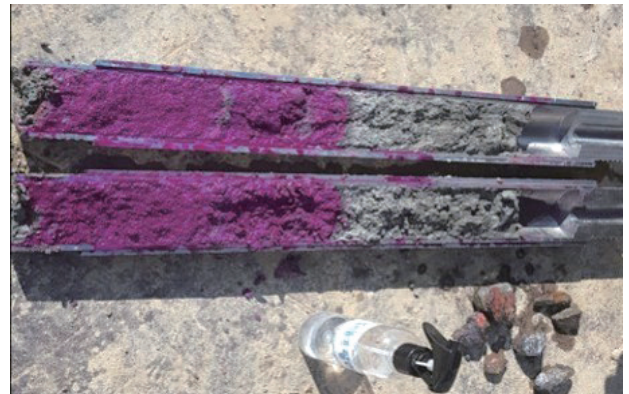
(T.S.M 시공 후 착색 후 시험)
